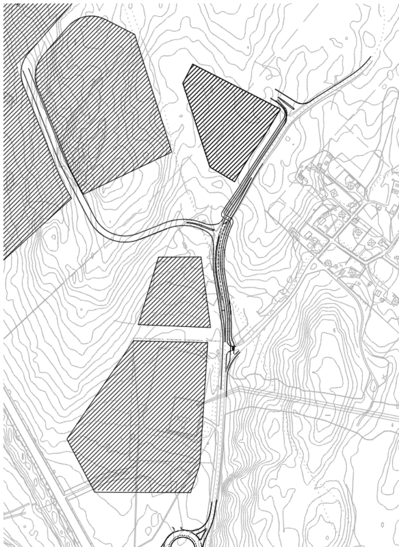
Figur 1 Bortvalt alternativ C3, trevägskorsning med 80 meter långt vänstersvängkörfält på Stenstavägen.
