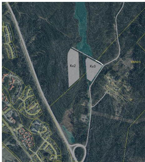
Figur 6 - Etapp 1: En byggväg anläggs vid den norra infarten för att möjliggöra uttag av berg i kvarter 2. Massorna kan användas vid byggnation av väggkropp och skyddsvall samt av kvarter 3
