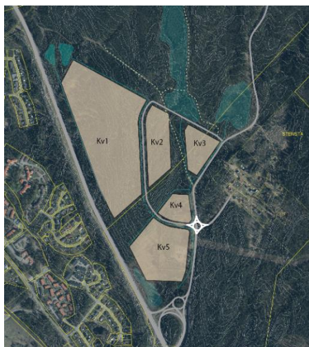
Figur 6 - Etapp 4: I samband med exploatering av resterande del av kvarter 1 och kvarter 5 anläggs cirkulationsplatsen som den sista åtgärden på allmän platsmark.
