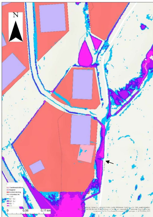
Figur 6-4 Inzoomning över översvämning på väg som leder till transformatorstation.
