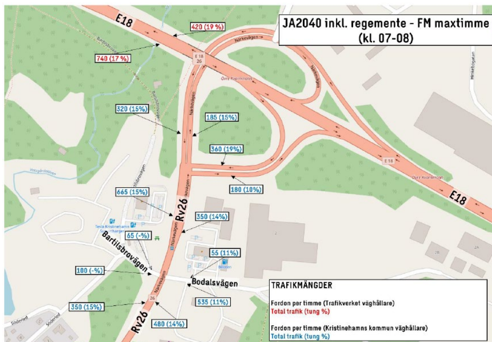
Bild: Trafikmängd för prognosår med regemente under förmiddagens maxtimme. Inledande trafikutredning Harberget, Förslag till väganslutningar till det nya regementet A9 på Harberget i Kristinehamns kommun, Sweco 2024-08-12.
