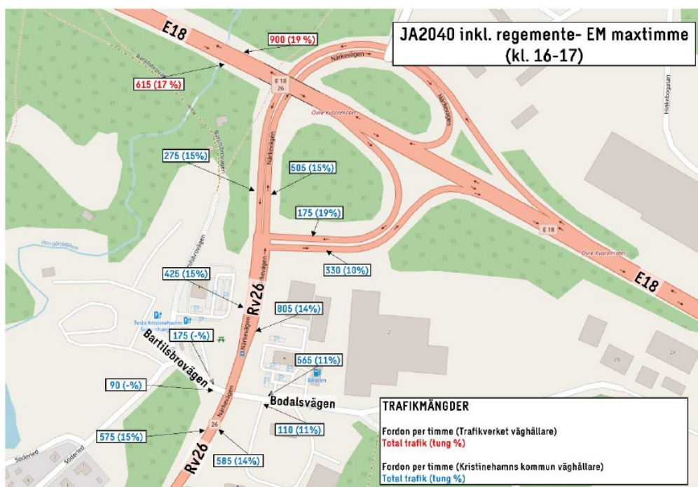
Bild: Trafikmängd för prognosår med regemente under eftermiddagens maxtimme. Inledande trafikutredning Harberget, Förslag till väganslutningar till det nya regementet A9 på Harberget i Kristinehamns kommun, Sweco 2024-08-12.
