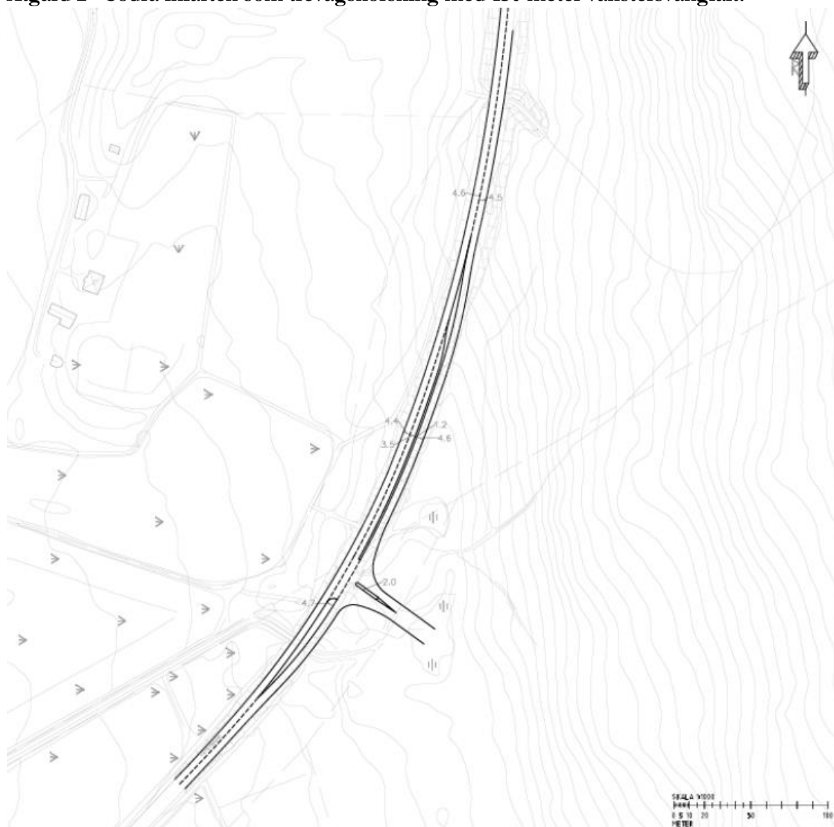
Bild: Trevägskorsning med vänstersvängfält till Harbergets södra anslutning. Inledande trafikutredning Harberget, Förslag till väganlutningar till det nya regementet A9 på Harberget i Kristinehamns kommun, Sweco 2024-08-12.
