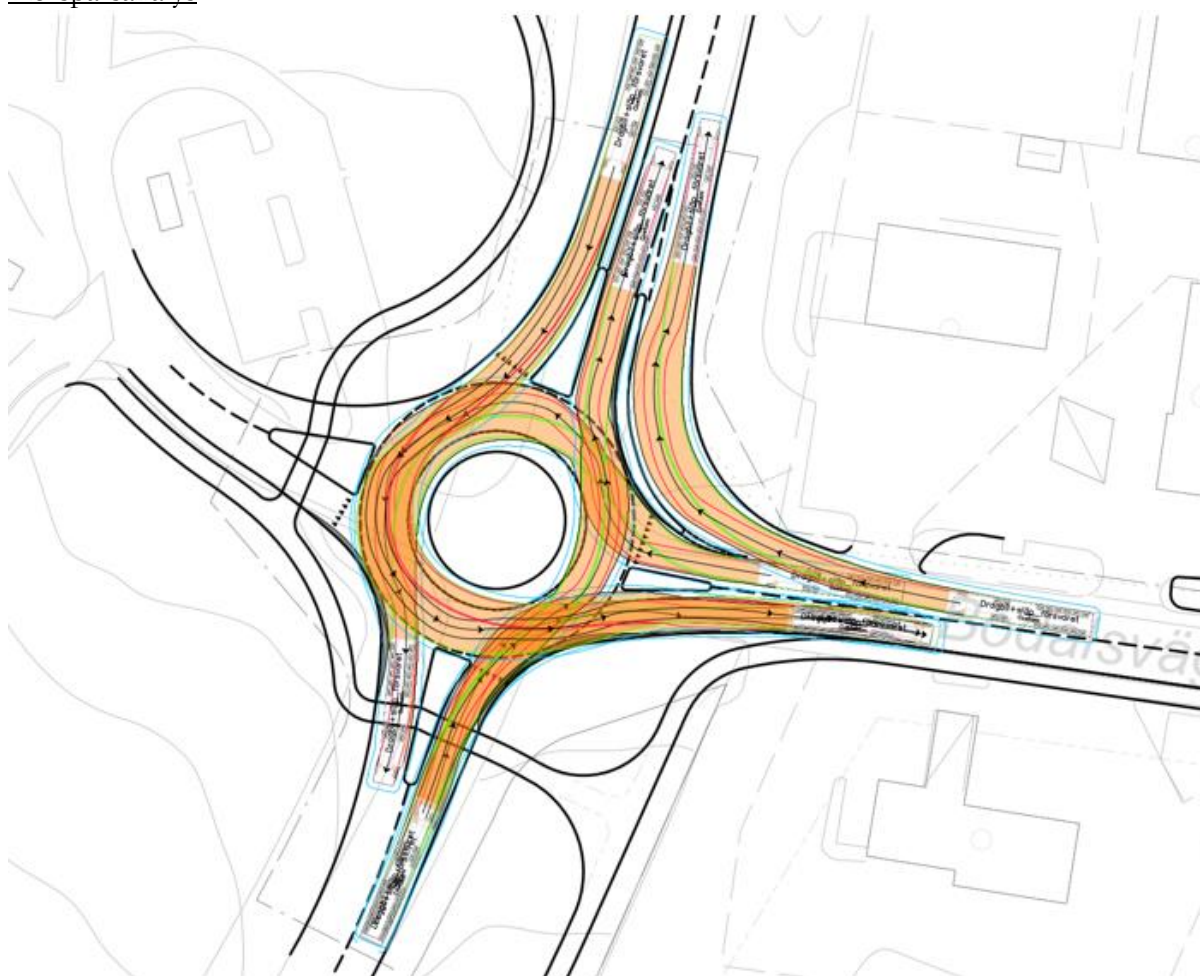
Bild: Körspårsanalys för föreslagen utformning med en meters extra "vingelutrymme" för ovana förare.
