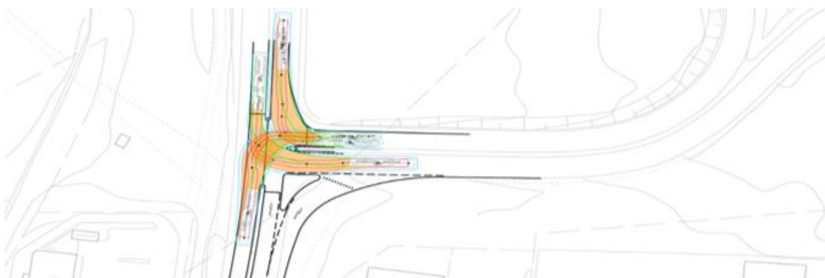
Bild: Körspårsanalys Kvarnmotet.. Inledande trafikutredning Harberget, Förslag till väganslutningar till det nya regementet A9 på Harberget i Kristinehamns kommun, Sweco 2024-08-12.
