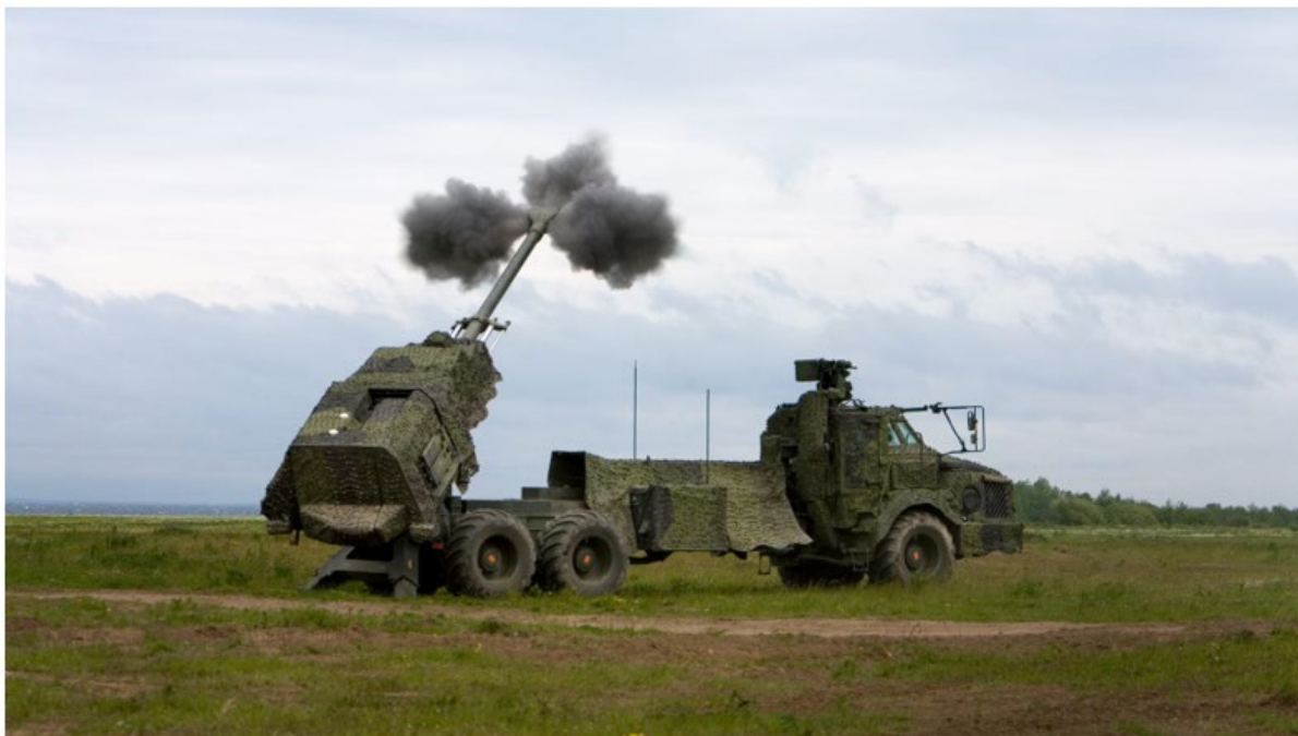
Bild: Fordonstypen Archer, en variant av artilleripjäsen Haubits 77B, där pjäsens överlavett har monterats på en terrängvagn som dras av en tungdragare. Inledande trafikutredning Harberget, Förslag till väkanslutningar till det nya regementet A9 på Harberget i Kristinehamns kommun, Sweco 2023-11-07.
