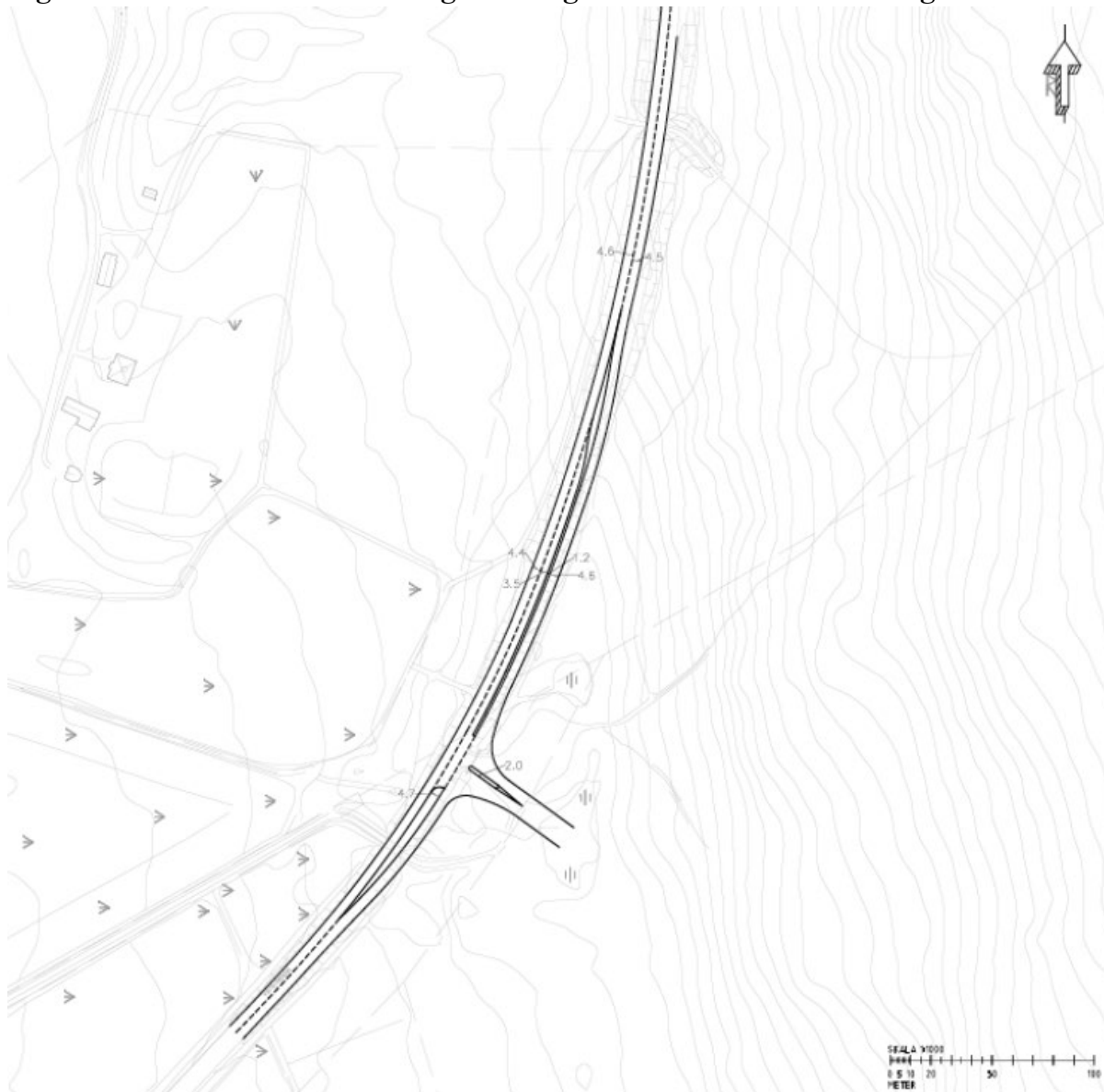
Bild: Trevägskorsning med vänstersvängfält till Harbergets södra anslutning. Inledande trafikutredning Harberget, Förslag till väganlutningar till det nya regementet A9 på Harberget i Kristinehamns kommun, Sweco 2023-11-07.
