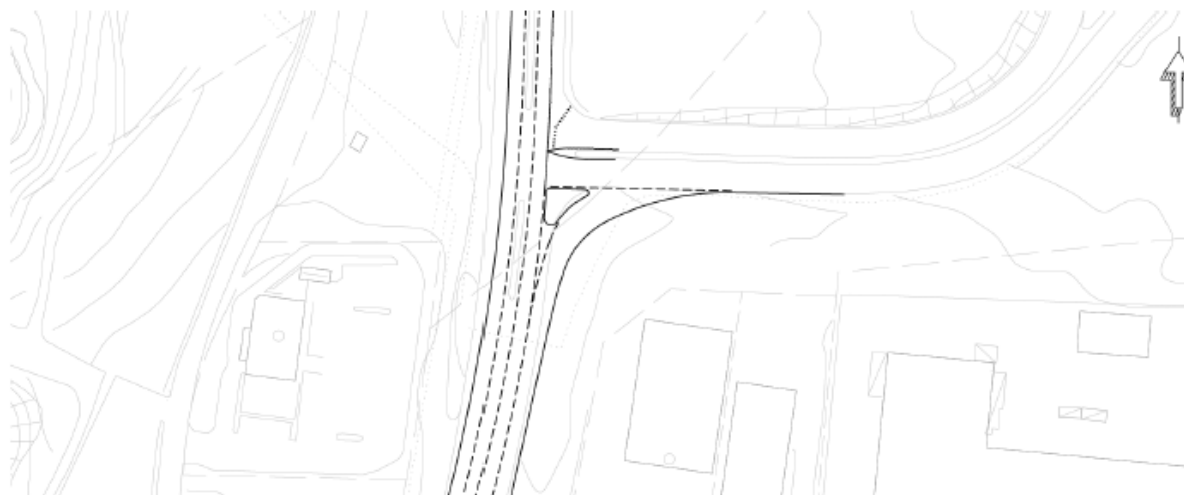
Bild: Utformningsförslag på Kvarnmotets trafikplats för att hantera ett extra körfält söderifrån. Inledande trafikutredning Harberget, Förslag till vägenslutningar till det nya regementet A9 på Harberget i Kristinehamns kommun, Sweco 2023-11-07.
