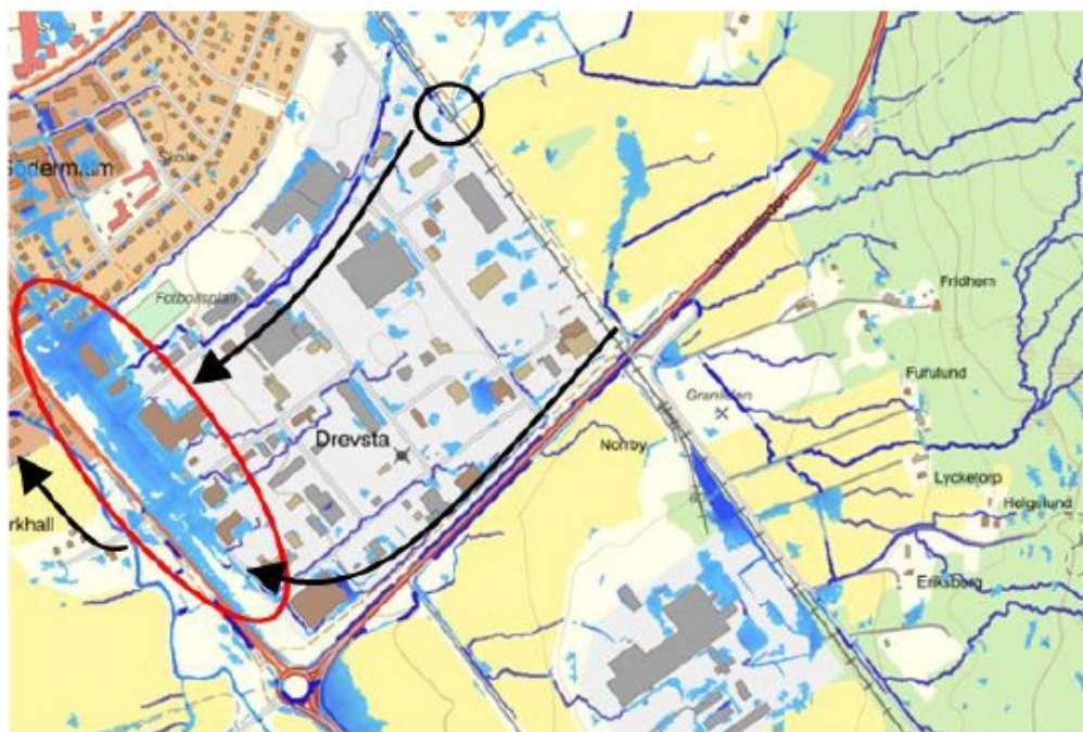
Bild: Lågpunkter utanför planområdet som får stående vatten vid skyfall idag. Röd markering visar lågpunkter och pilarna avrinningsriktning. Svart markering är kulverterat dike. Skyfallsutredning Regemente A9 Kristinehamn Sweco 2023-08-29.
