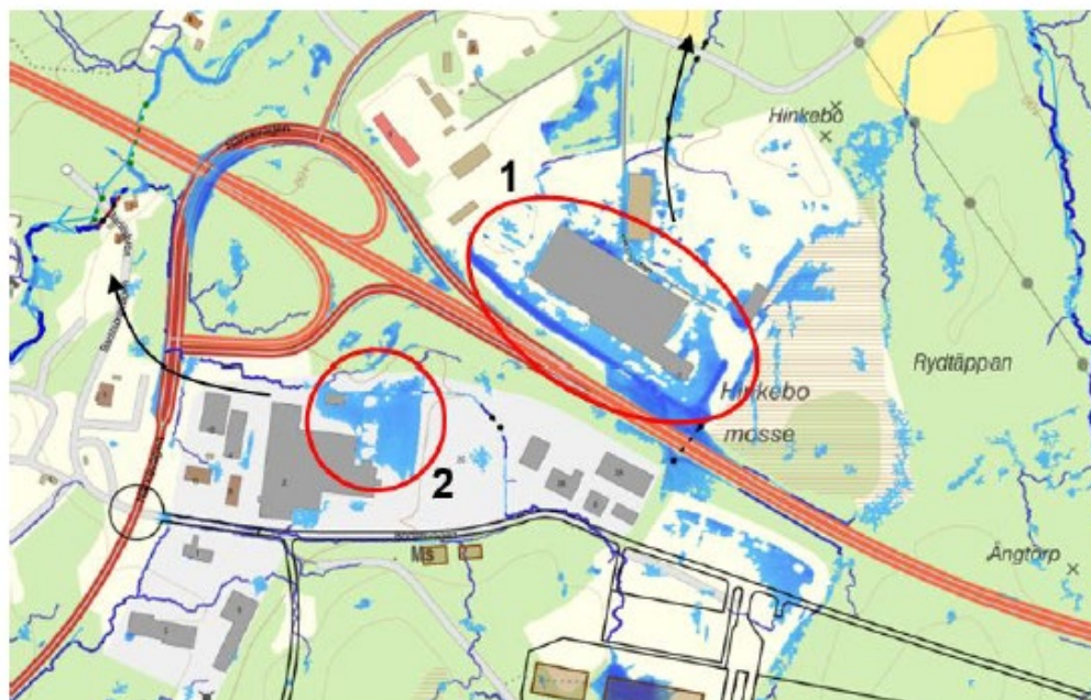
Bild: Lågpunkter utanför planområdet som får stående vatten vid skyfall idag. Röd markering visar lågpunkter och pilarna avrinningsriktning. Skyfallsutredning Regemente A9 Kristinehamn Sweco 2023-08-29.
