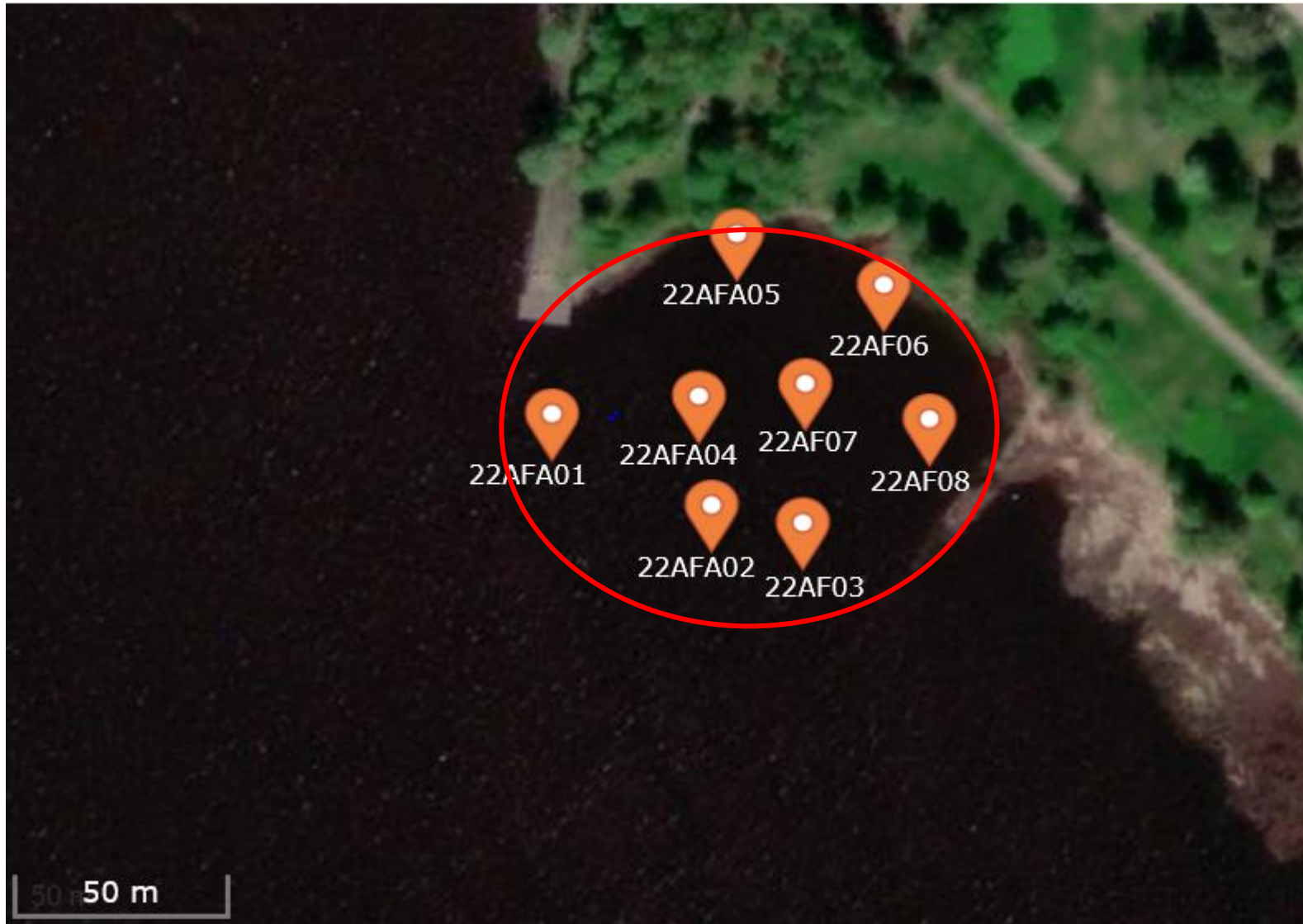
Bilaga 1: Situationsplan: De åtta provtagningspunkterna på ett ortofoto av undersökningsområdet. Källa: Skarp Miljökonsult och AFRY, ortofoto Havs- och vattenmyndigheten
