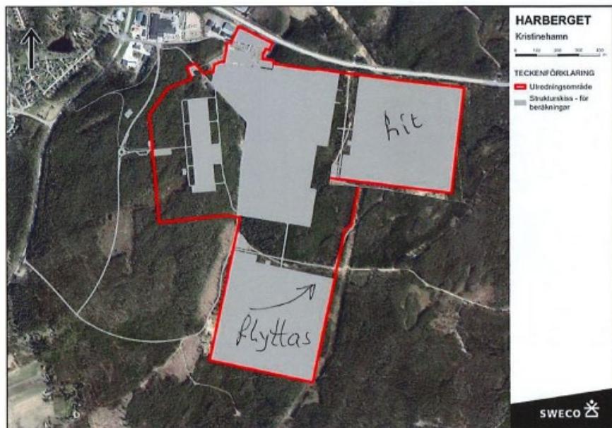
Bild: Ytor inom utredningsområdet som beräknas hårdgöras. Dagvattenutredning A9, Harberget Kristinehamn Fortifikationsverket, Sweco 2023-08-29.
