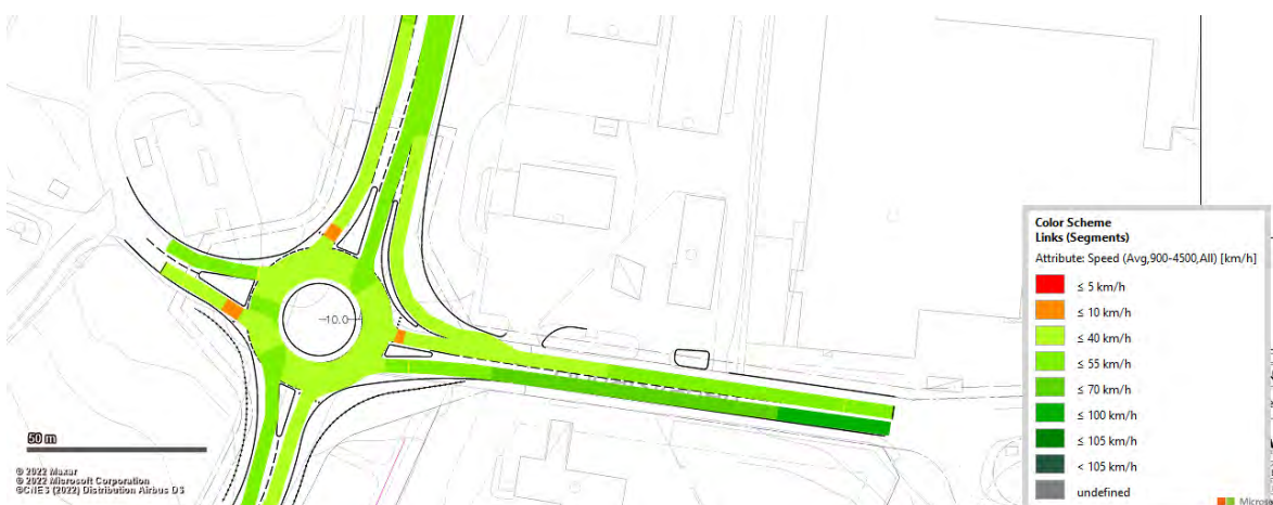
Figur 84 Vissim-test (Heatmap) för projektprognos (steg 4) för Alternativ 1C och 1D för den norra infarten under eftermiddagens maxtimme
