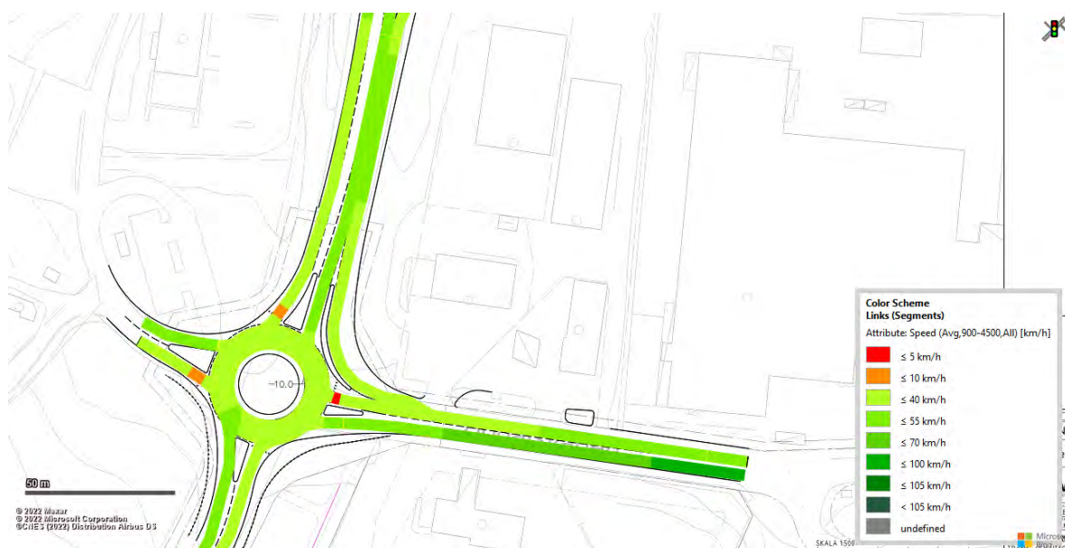
Figur 98 Vissim-test (Heatmap) för känslighetsprognos (steg 5) för Alternativ 1C och 1D för den norra infarten under eftermiddagens maxtimme
