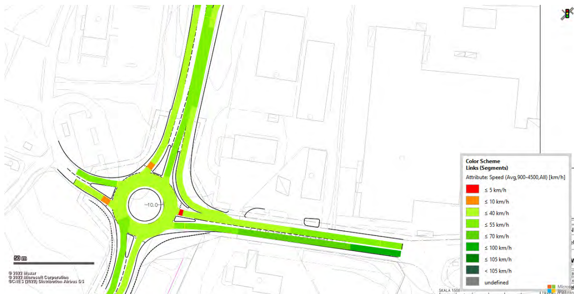
Figur 88 Vissim-test (Heatmap) för känslighetsprognos (steg 5) för Alternativ 1C och 1D för den norra infarten under eftermiddagens maxtimme
