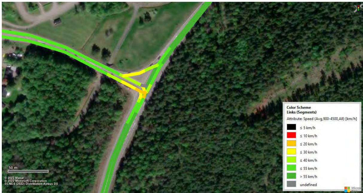
Figur 47. Vissim-test (Heatmap) för projektprognosen STEG 4 vid Närkevägen med förmiddagens, befintlig infrastruktur
