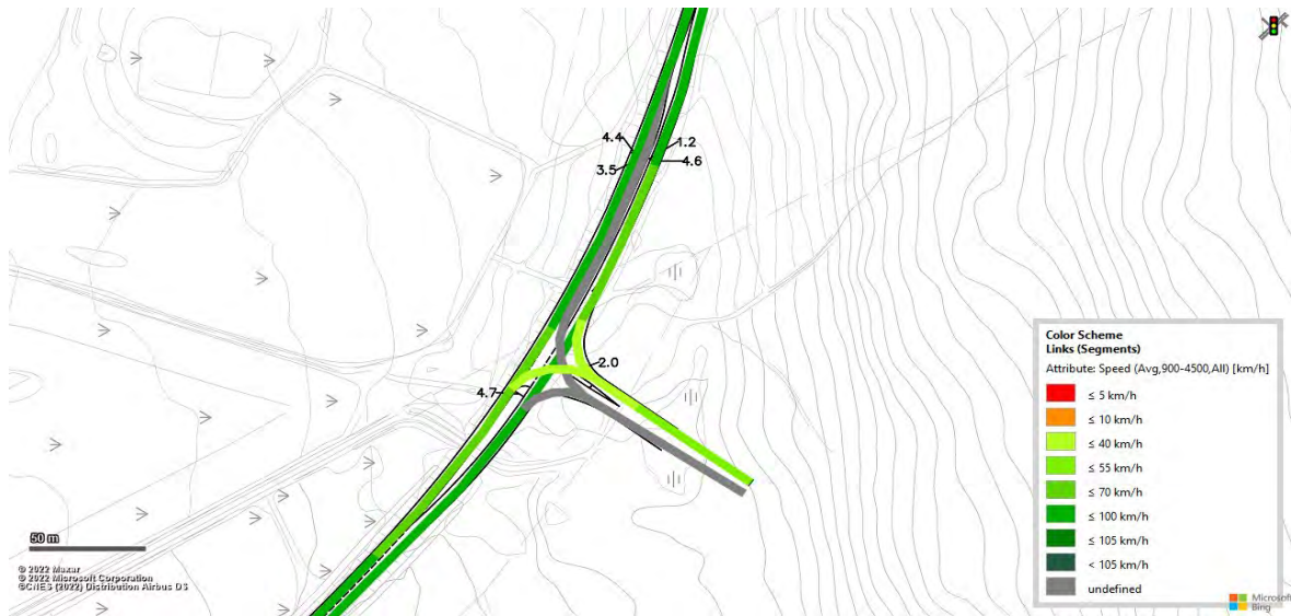
Figur 136 Vissim-test (Heatmap) för projektprognos (steg 4) för alternativ 2B-D under eftermiddagens maxtimmestrafik
