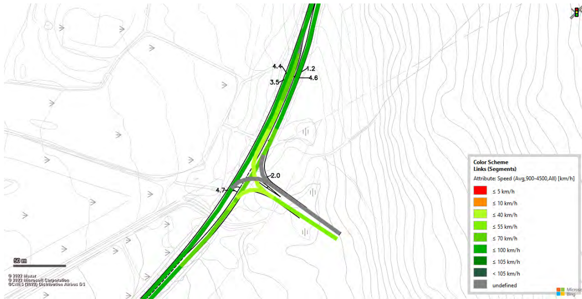
Figur 160 Vissim-test (Heatmap) för projektprognos (steg 5) för alternativen 2B-D under eftermiddagens maxtimmestrafik
