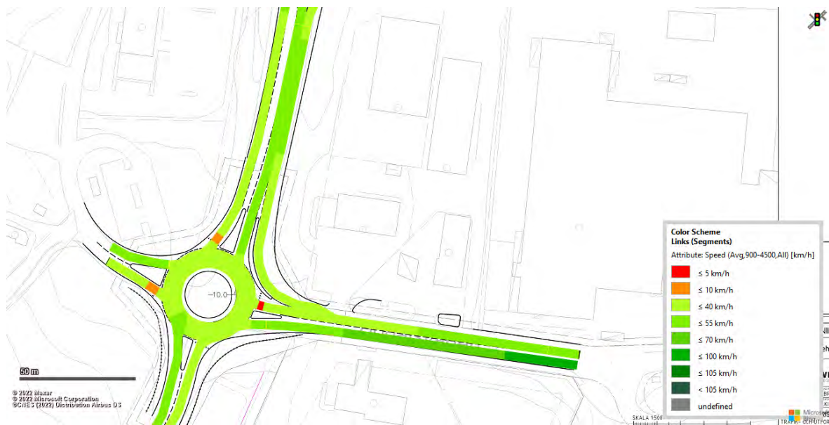
Figur 107 Vissim-test (Heatmap) för känslighetsprognos (steg 5) för Alternativ 1C och 1D för den norra infarten under eftermiddagens maxtimme
