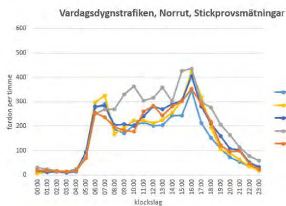
Figur 240 Vardagsdygnstrafiken stickprovsmätningar (diagrammet till höger) och sportlovsmätning v. 7 (diagrammet till vänster) - norrgående riktning.
