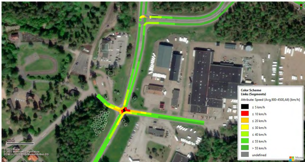
Figur 36. Vissim-test (Heatmap) för delprognosen STEG 3 under eftermiddagens maxtimme.
