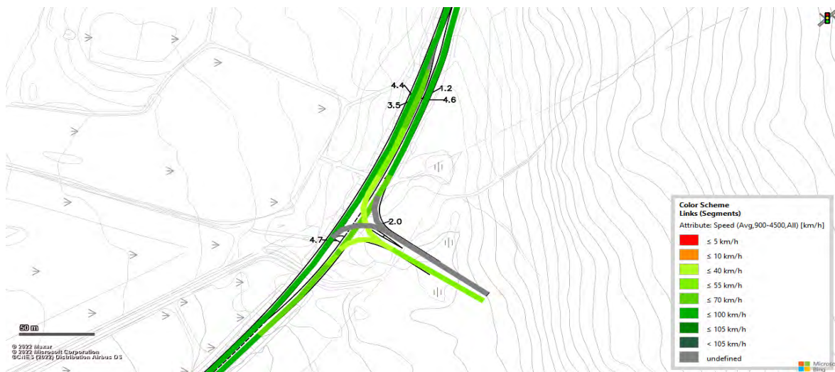
Figur 144 Vissim-test (Heatmap) för projektprognos (steg 4) för alternativen 2B-D under förmiddagens maxtimme trafik
