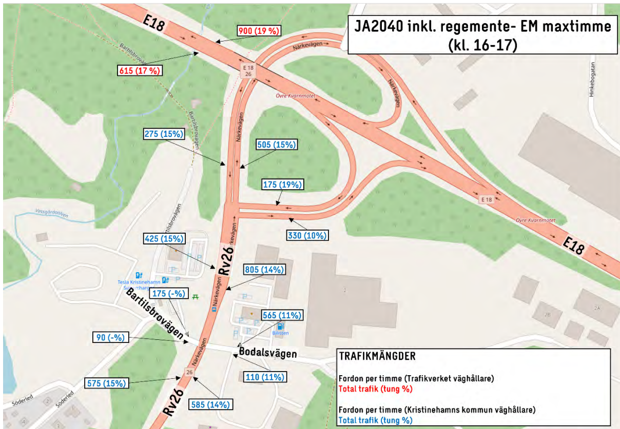
Figur 43. Trafikmängd för projektprognosen (steg 4) under eftermiddagens maxtimme.
