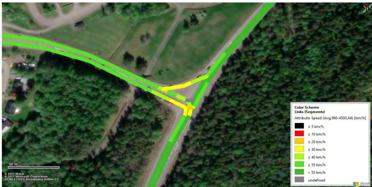
Figur 21 Vissim-test (Heatmap) för Närkevägen – Nulägestrafik under förmiddagens maxitime
