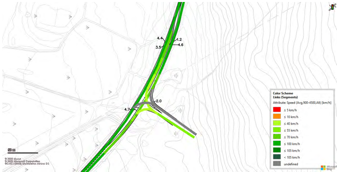
Figur 140 Vissim-test (Heatmap) för projektprognos (steg 5) för alternativen 2B-D under eftermiddagens maxtimmestrafik
