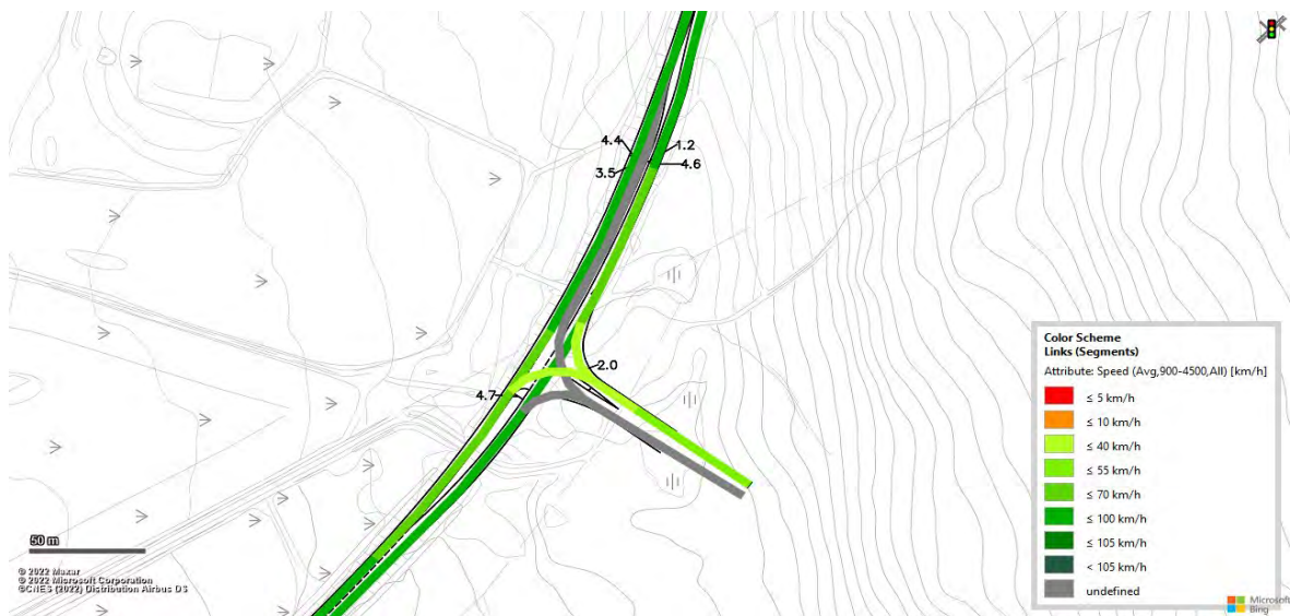
Figur 156 Vissim-test (Heatmap) för projektprognos (steg 4) för alternativen 2B-D under eftermiddagens maxtimmertrafik
