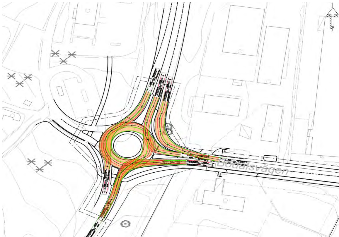
Figur 74 Körspårskontroll för tungdragare med släp i Alternativ 1B, 1C och 1D enfältig cirkulation med högersvängfält
