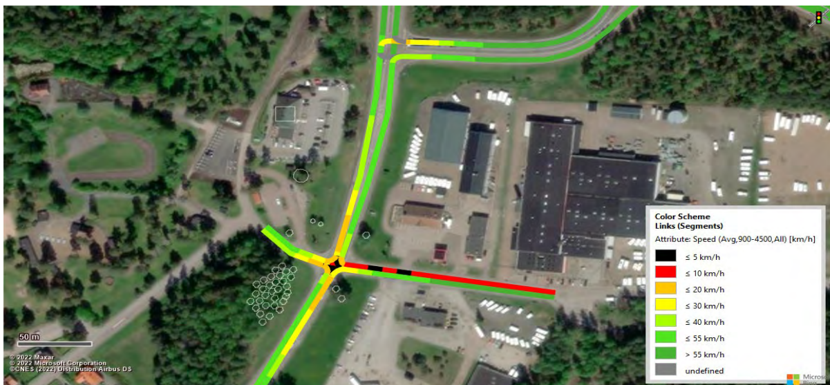
Figur 129 Vissim-test (Heatmap) för projektprognosen (Steg 4) vid eftermiddagens maxtimme, befintlig infrastruktur.
