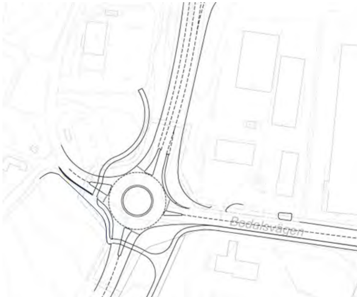
Figur 99 Alternativ 1Db– Norra infarten som enkelfilig cirkulationsplats med passage för med passage för gående, cyklister och mopedister i söder och väster och med extra höger-ut svängfält från öster mot norr samt dubbelfilighet norrut. Körfält extra brett (9 meter).
