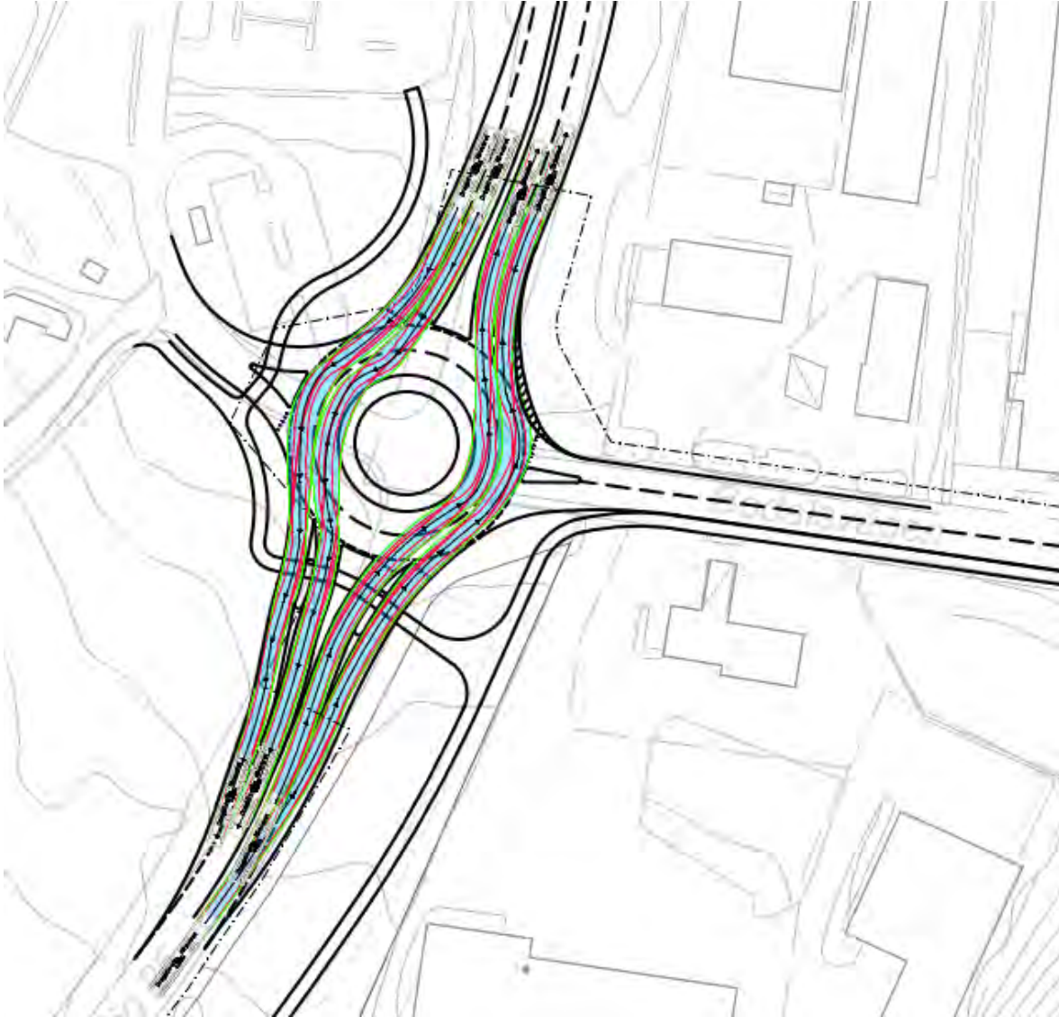
Figur 125 Körspårsanalys för alternativ 1E, fokus på trafik som ska rakt igenom cirkulationen längs väg 26.
