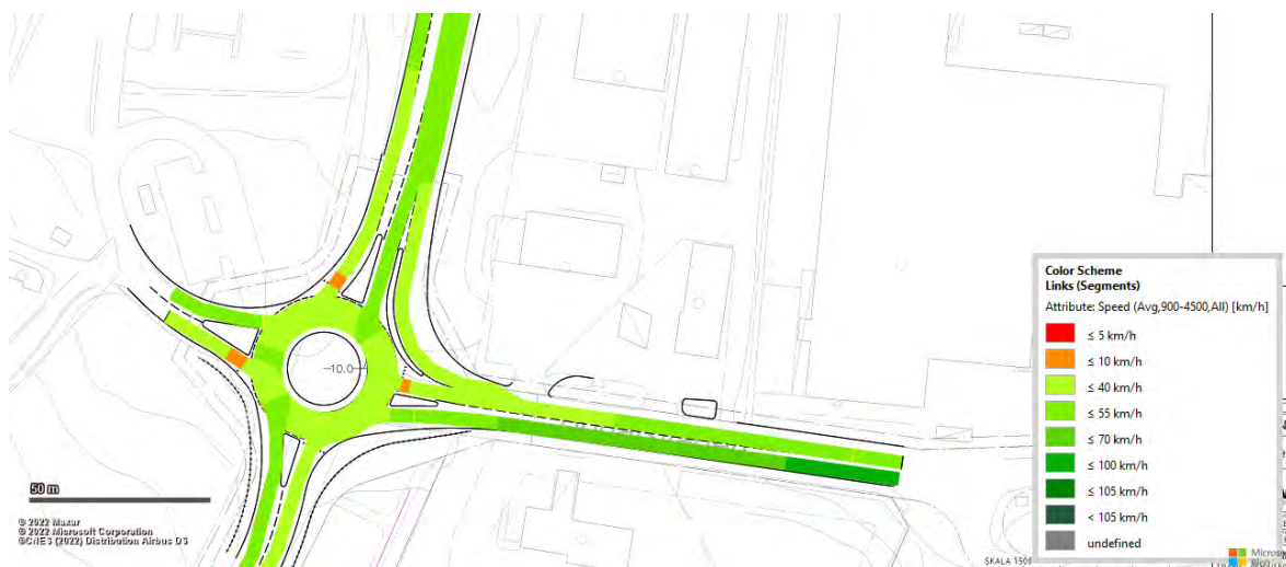
Figur 104 Vissim-test (Heatmap) för projektprognos (steg 4) för Alternativ 1C och 1D för den norra infarten under eftermiddagens maxtimme
