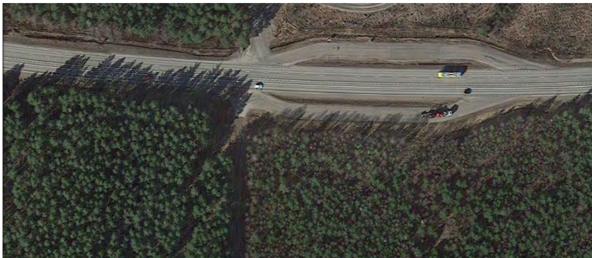
Figur 204 Utfart från "timmervägen" till E18. Timmervägen är den mörka vägen mitt i bilden, Utfart möjlig enbart åt öster, antingen direkt ut i körbanan eller via den södra lastbilsfickan.
