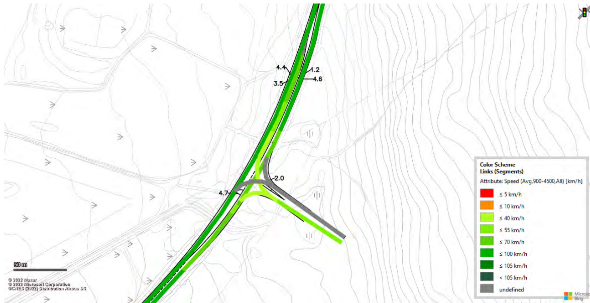
Figur 150 Vissim-test (Heatmap) för projektprognos (steg 5) för alternativ 2B-D under eftermiddagens maxtimstrafik
