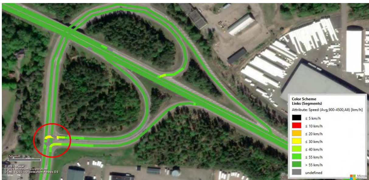
Figur 19 Vissim-test (Heatmap) för Övre Kvarnmotet - Nulägestrafik under eftermiddagens maxtimme.
