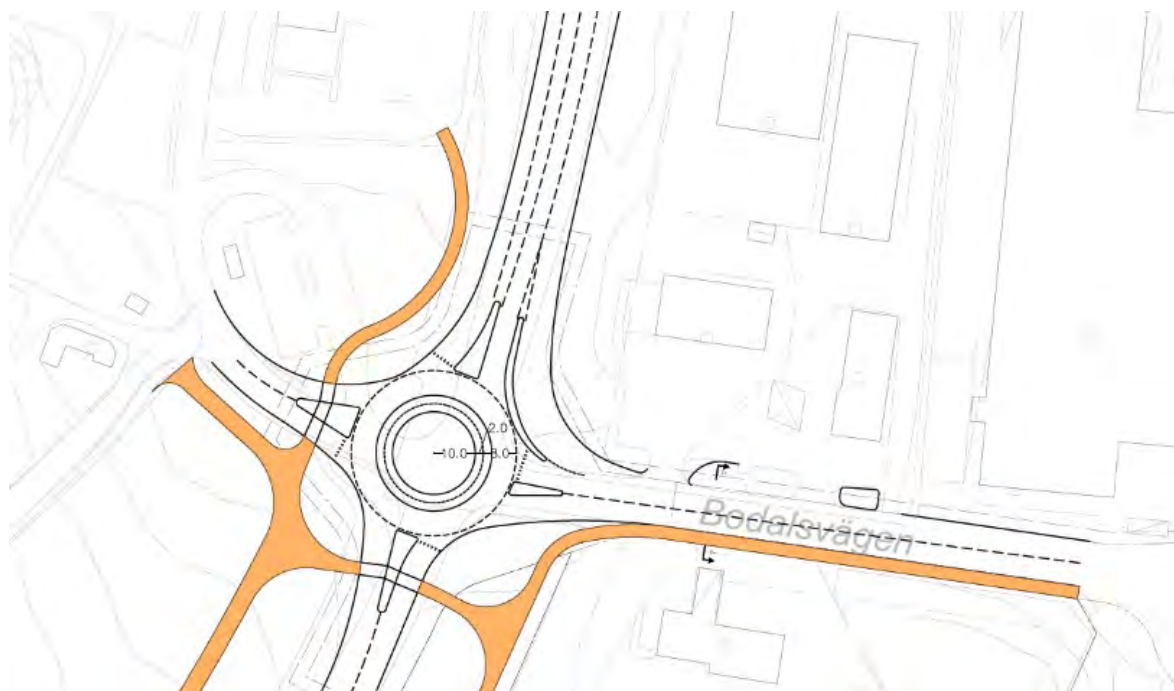
Figur 89 Alternativ 1Da– Norra infarten som enkelfilig cirkulationsplats med passage för cykel i söder och väster och med extra höger-ut svängfält från öster mot norr samt dubbelfilighet norrut
