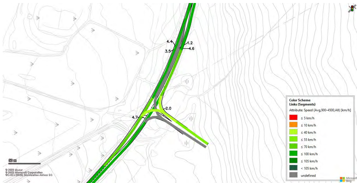
Figur 158 Vissim-test (Heatmap) för projektprognos (steg 5) för alternativ 2B-D under förmiddagens maxtimme trafik
