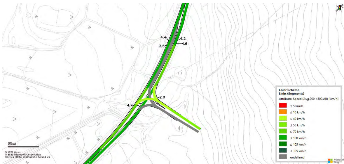
Figur 146 Vissim-test (Heatmap) för projektprognos (steg 4) för alternativen 2B-D under eftermiddagens maxtimme trafik
