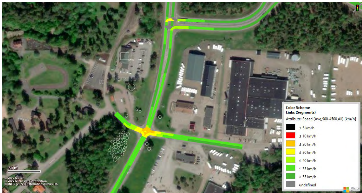
Figur 13. Vissimtest (Heatmap) för nulägestrafik (steg 1) under förmiddagens maxtimme.
