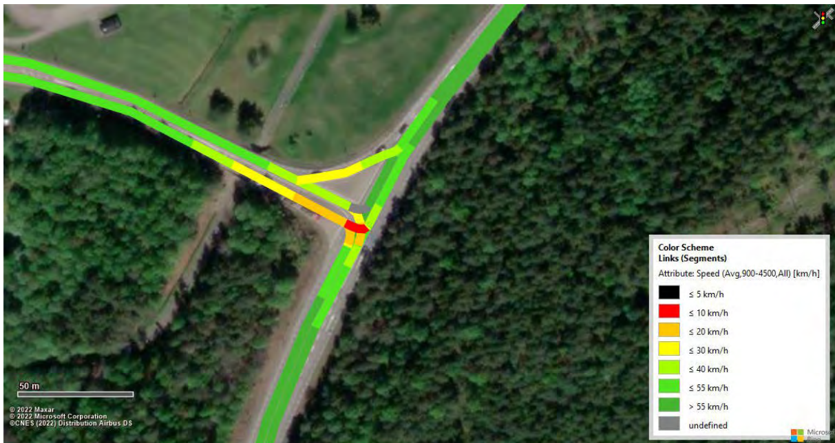
Figur 166 Vissim-test (Heatmap) för projektprognosen (Steg 4) för Närkevägen med förmiddagens maxtimme trafik, givet en trevägskorsning i söder som infart till Harberget samt att norra infarten byggts om till en cirkulationsplats (1A-1D).
