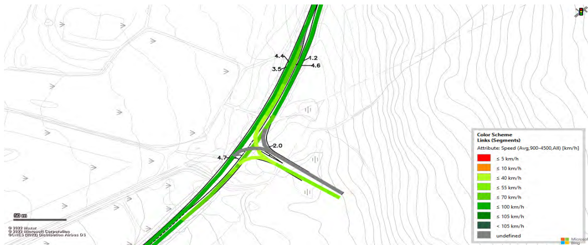
Figur 155 Vissim-test (Heatmap) för projektprognos (steg 4) för alternativen 2B-D under förmiddagens maxtimme trafik
