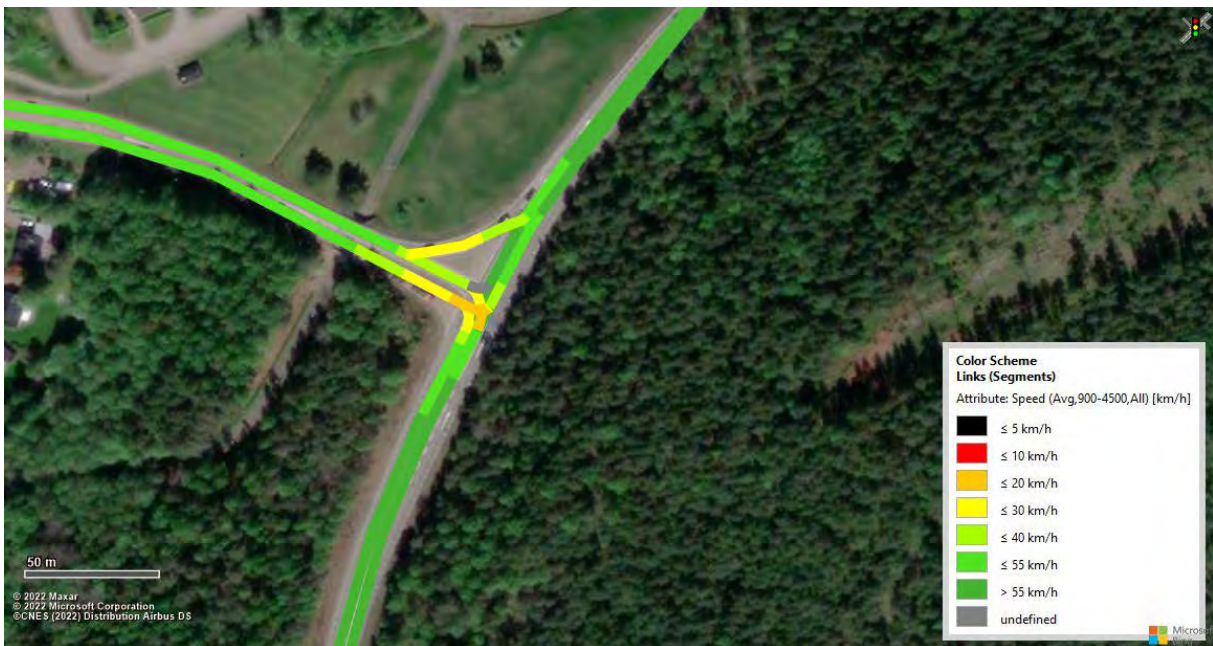
Figur 167 Vissim-test (Heatmap) för projektprognosen (Steg 4) för Närkevägen med eftermiddagens maxtimme trafik, givet en trevägskorsning i söder som infart till Harberget samt att norra infarten byggts om till en cirkulationsplats (1A-1D)..
