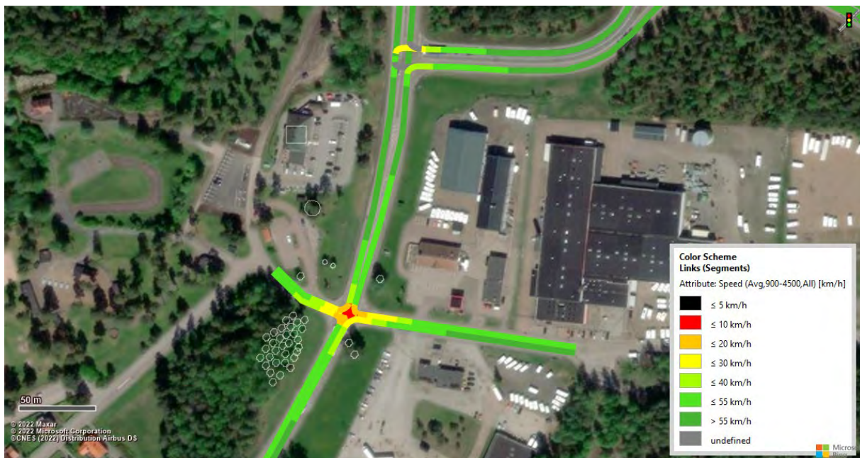
Figur 15. Vissim-test (Heatmap) för nulägestrafik under eftermiddagens maxtimme.
