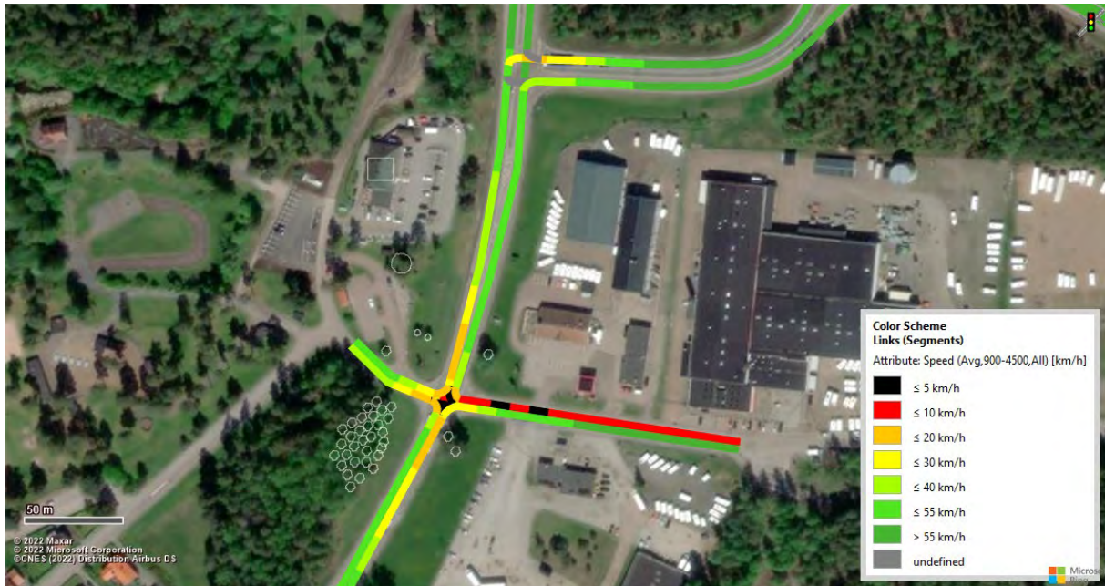
Figur 45. Vissim-test (Heatmap) för projektprognosen STEG 4 vid eftermiddagens maxtimme, befintlig infrastruktur.
