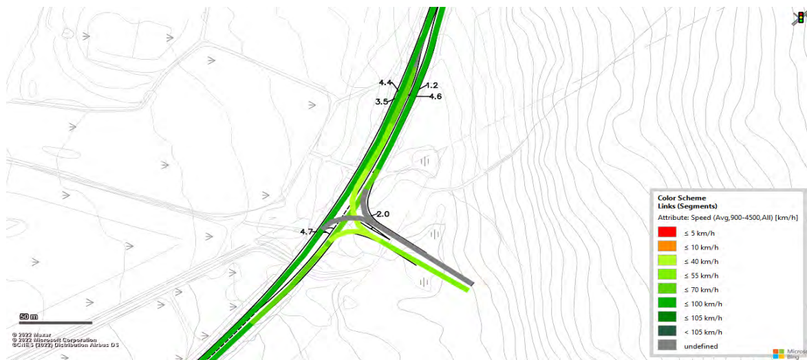
Figur 134 Vissim-test (Heatmap) för projektprognos (steg 4) för alternativen 2B-D under förmiddagens maxtimme. Trafik.
