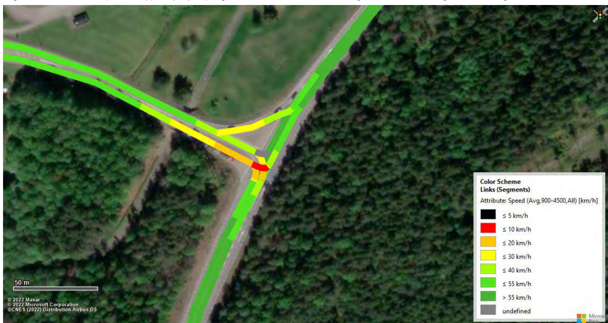
Figur 48. Vissim-test (Heatmap) för projektprognosen STEG 4 Närkevägen med eftermiddagens maxtimmestrafik, befintlig infrastruktur.
