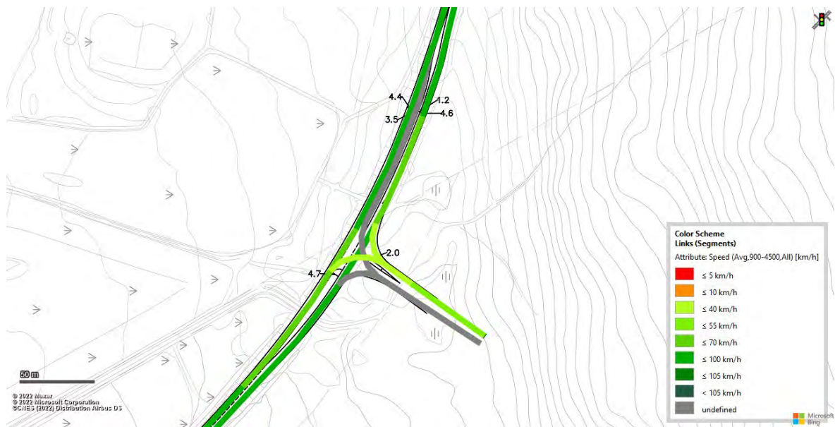
Figur 138 Vissim-test (Heatmap) för projektprognos (steg 5) för alternativ 2B-D under förmiddagens maxtimme trafik
