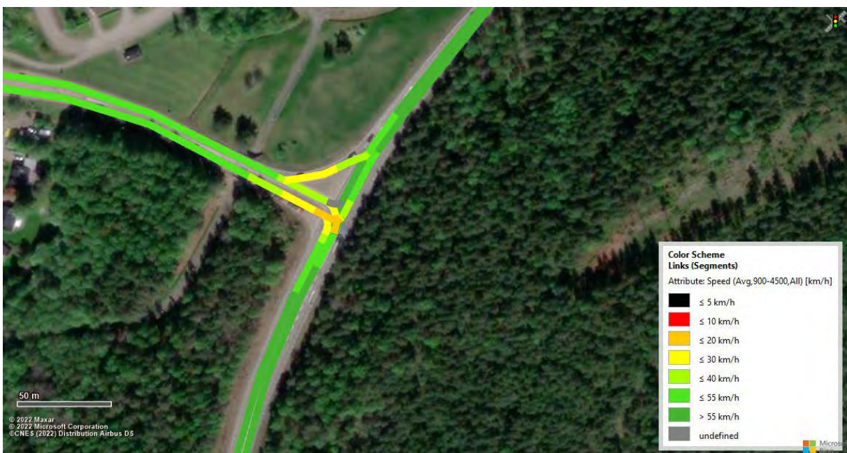
Figur 165 Vissim-test (Heatmap) för projektprognosen (Steg 4) för Närkevägen med eftermiddagens maxtimme trafik, givet oförändrad befintlig infrastruktur på väg 26 i hela området.
