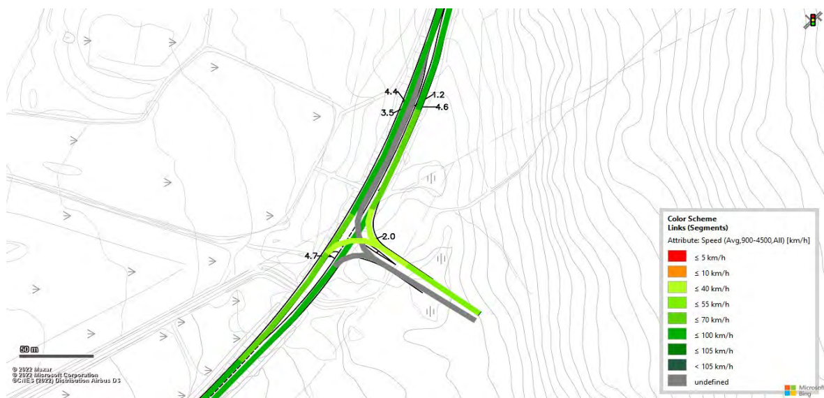
Figur 148 Vissim-test (Heatmap) för projektprognos (steg 5) för alternativen 2B-D under förmiddagens maxtimme trafik
