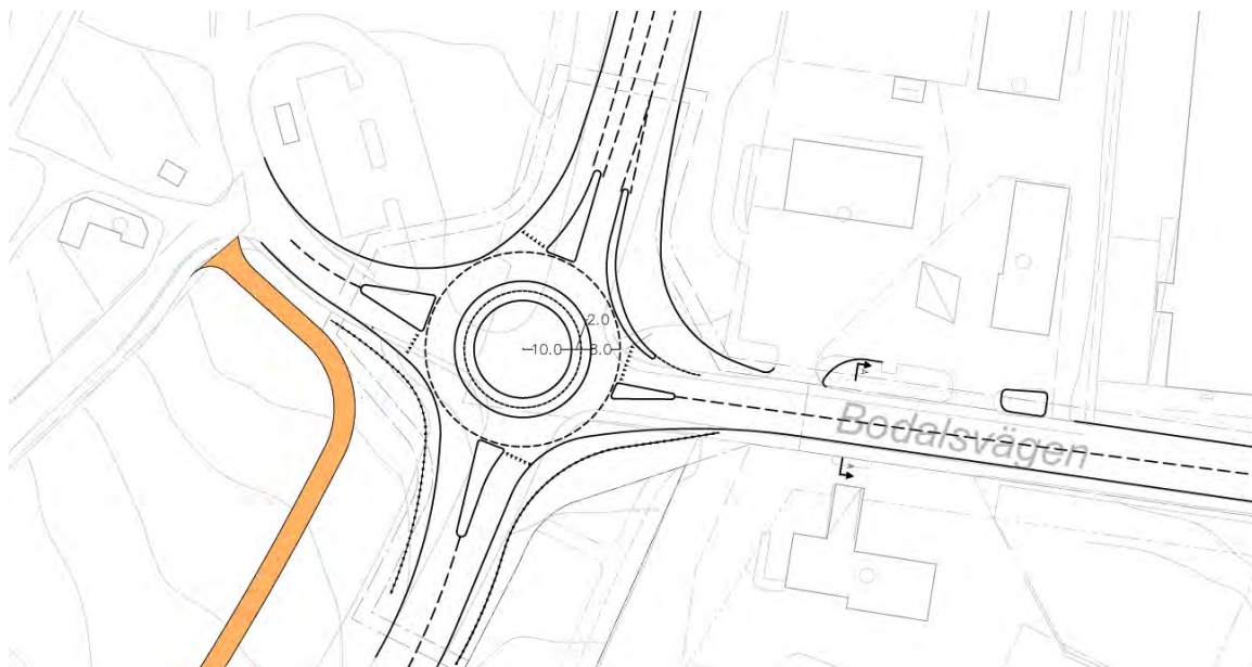
Figur 79 Utformningsförslag alternativ 1C Enkelfilig cirkulationsplats utan GCM-passage med extra höger-ut svängfält från öster mot norr samt dubbelfilighet norrut
