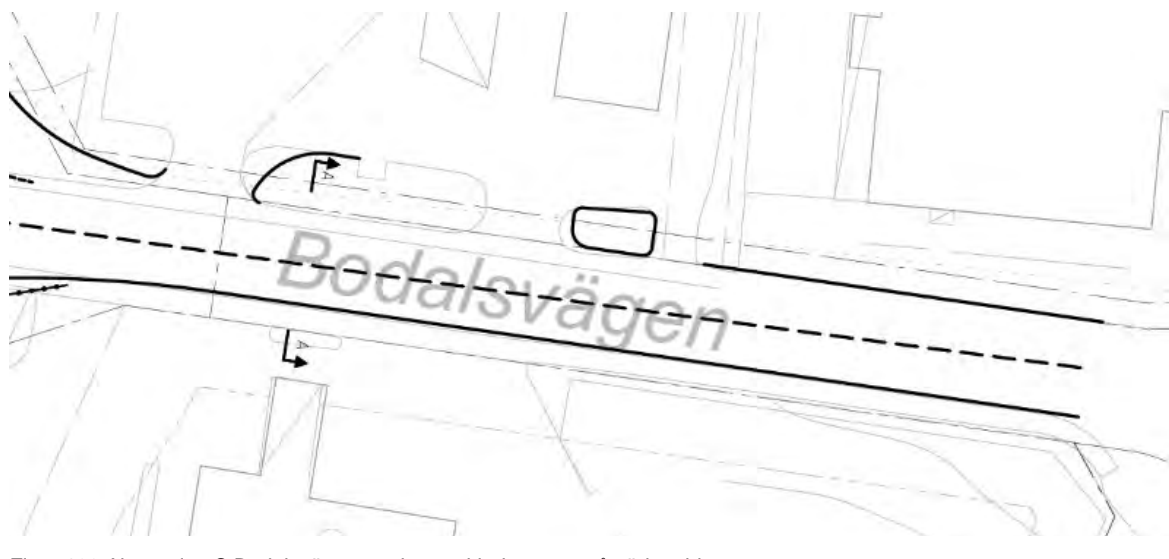
Figur 199 Alternativ 5C Bodalsvägen med avvecklad trottoar på södra sidan.
