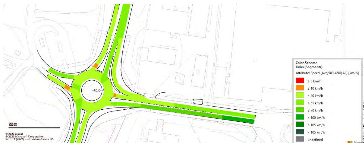
Figur 94 Vissim-test (Heatmap) för projektprognos (steg 4) för Alternativ 1C och 1D för den norra infarten under eftermiddagens maxitime
