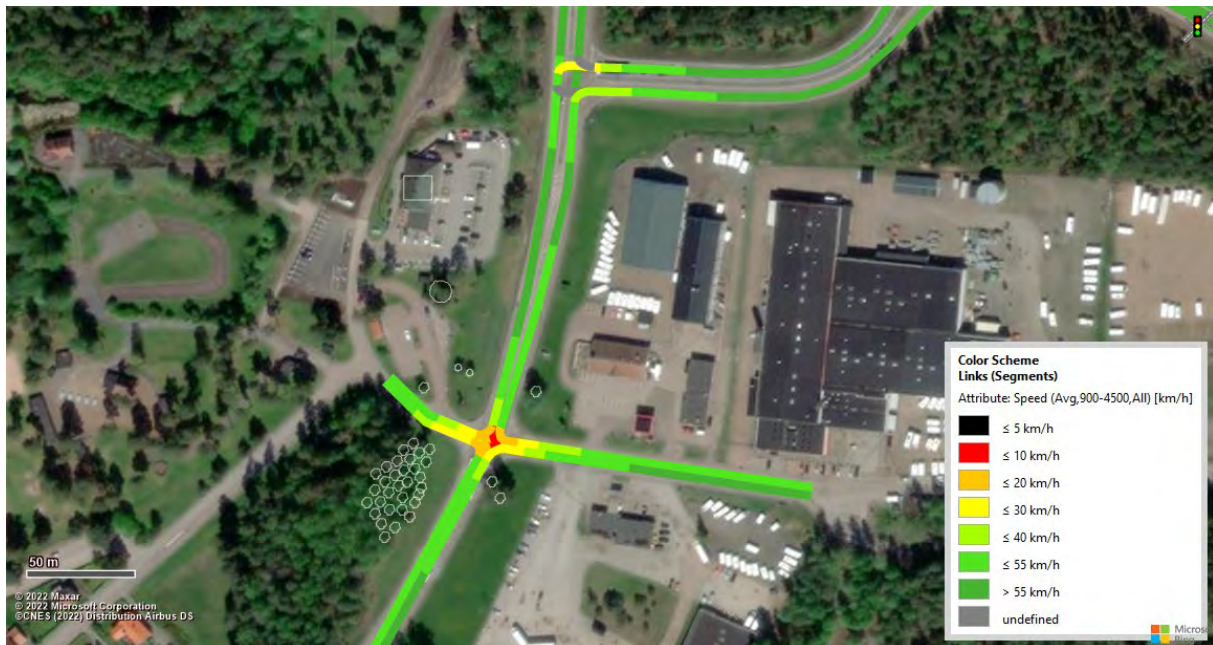
Figur 34. Vissim-test (Heatmap) för delprognosen JA STEG 3 under förmiddagens maxtimme.
