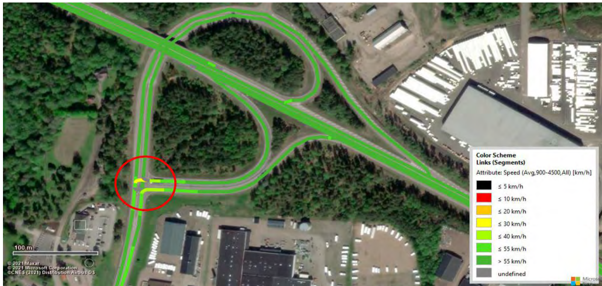
Figur 17 Vissim-test (Heatmap) för Övre Kvarnmotet - Nuläget under förmiddagens maxtimme.
